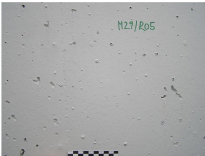
Bild 4: Mit Pinblisters übersäte Betonoberfläche
