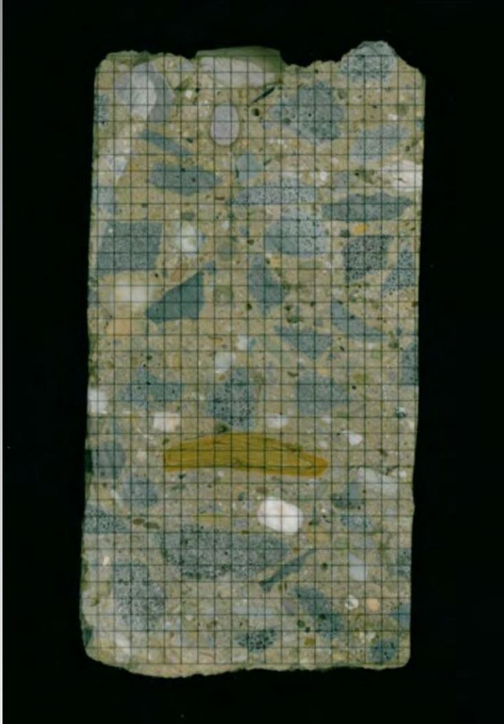
Sieblinie des Betons war aufgrund der zu hohen Anteile an säurelöslicher Schlacke nicht aus der Analyse zu gewinnen.
